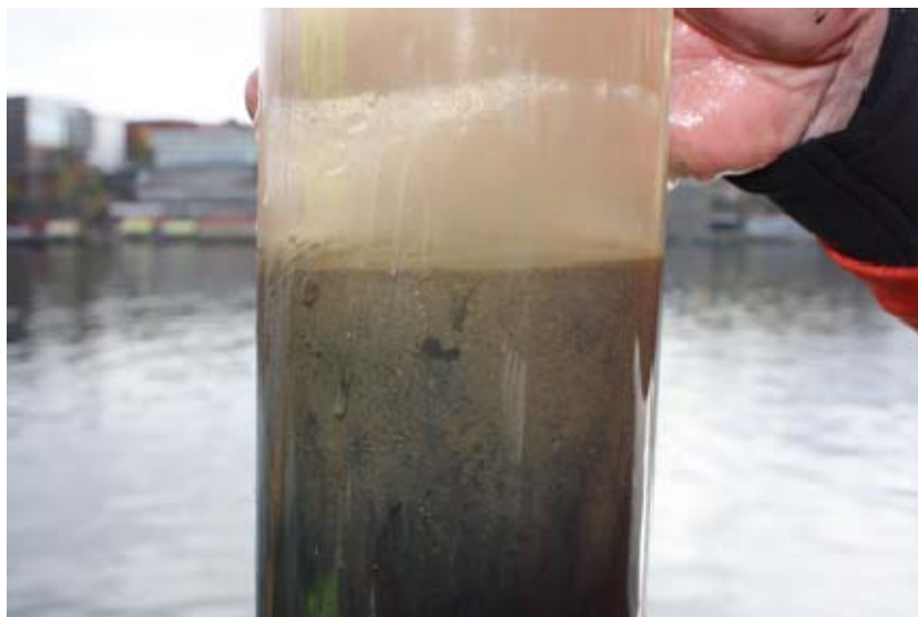
Figur 11. Typisk sedimentkärna från Saltsjön utanför Beckholmen. Oxiderat ytskikt på några cm överlagrande mörkt reducerat sediment. Notera djurgångarna i ytskiktet.
