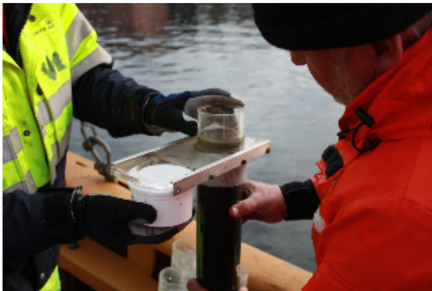
Figur 3. Snittning och provuttag av de översta 2 centimetrarna.
