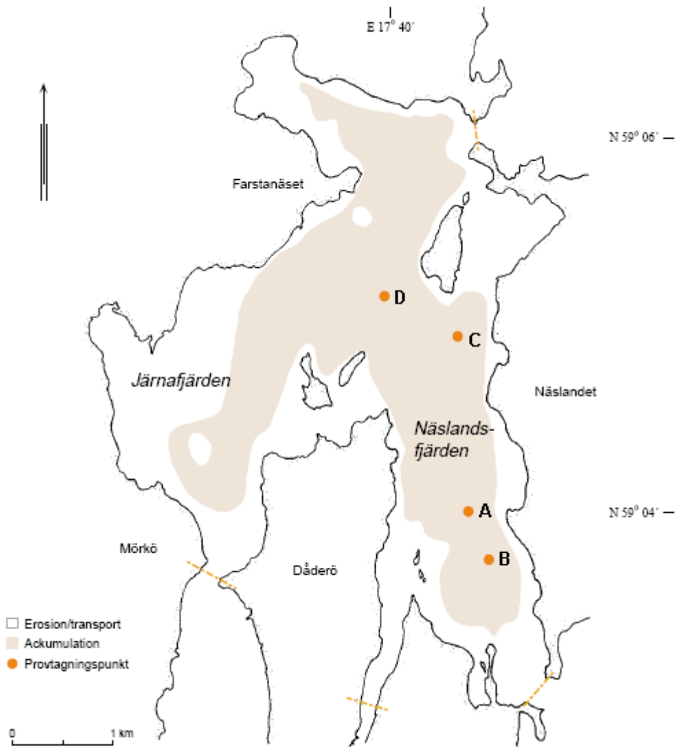
Figur 40 Bottendynamisk karta över Näslandsfjärden med provtagningsstationer
