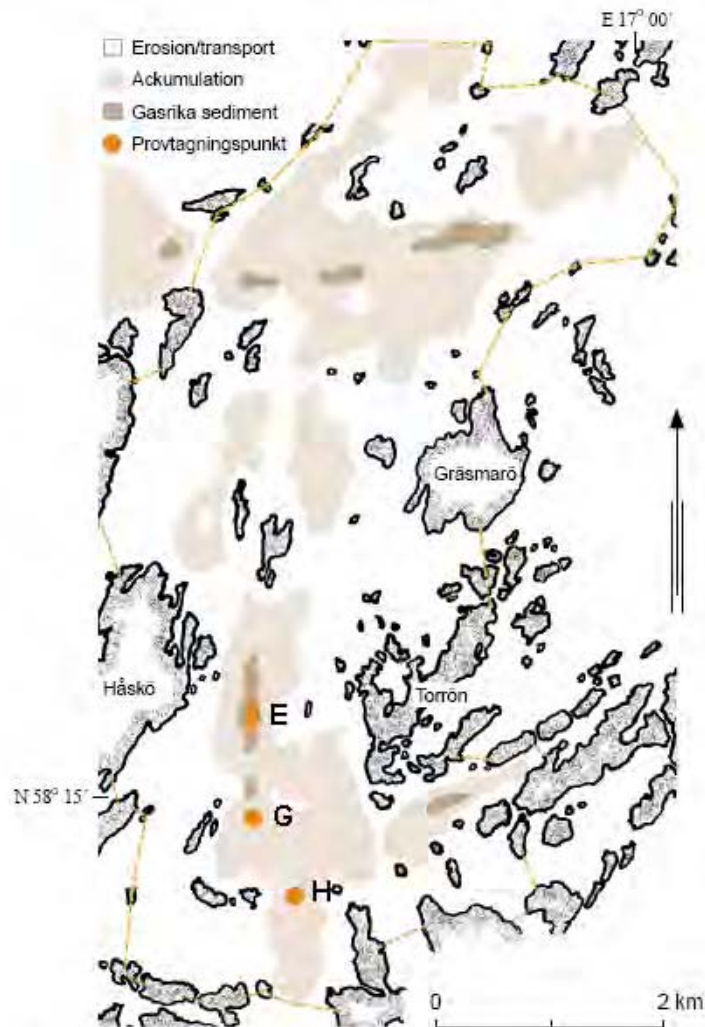
Figur 75 Bottendynamisk karta för Kullskärsdjupet med provtagningsstationer för sediment från 2009 inlagda.
