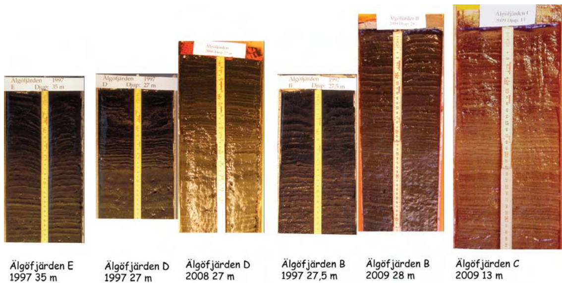
Figur 35 Jämförelse mellan kärnor i Älgöfjärden från provtagningar 1998 och 2009. Kärnorna har konnekterats tidsmässigt genom antal årsvarv.
