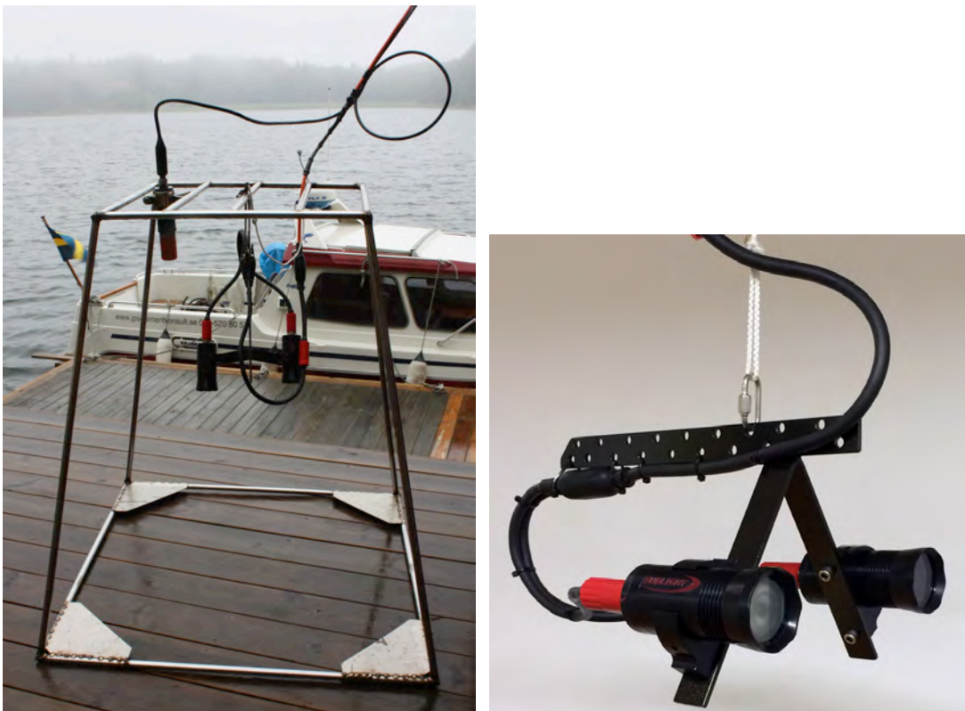
Figur 3 Bottenvideokamera av märket Sublight Technology med 100 m kabel.
