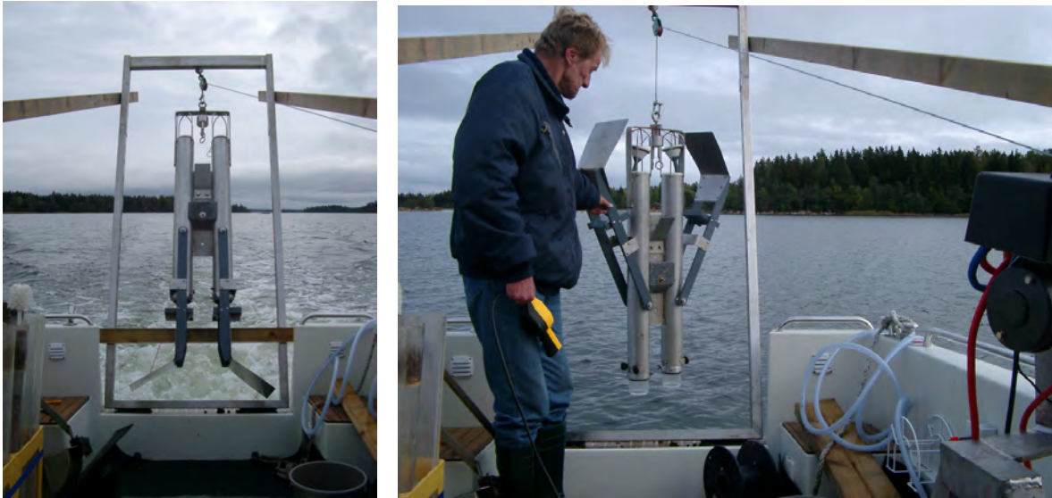
Figur 2 Vänstra bilden: Gemini-hämtaren surrad för transport. Högra bilden: Geminihämtaren laddad och redo för hugg.
