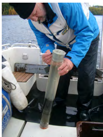
Figur 5 Preparering av sedimentkärna för transport.
