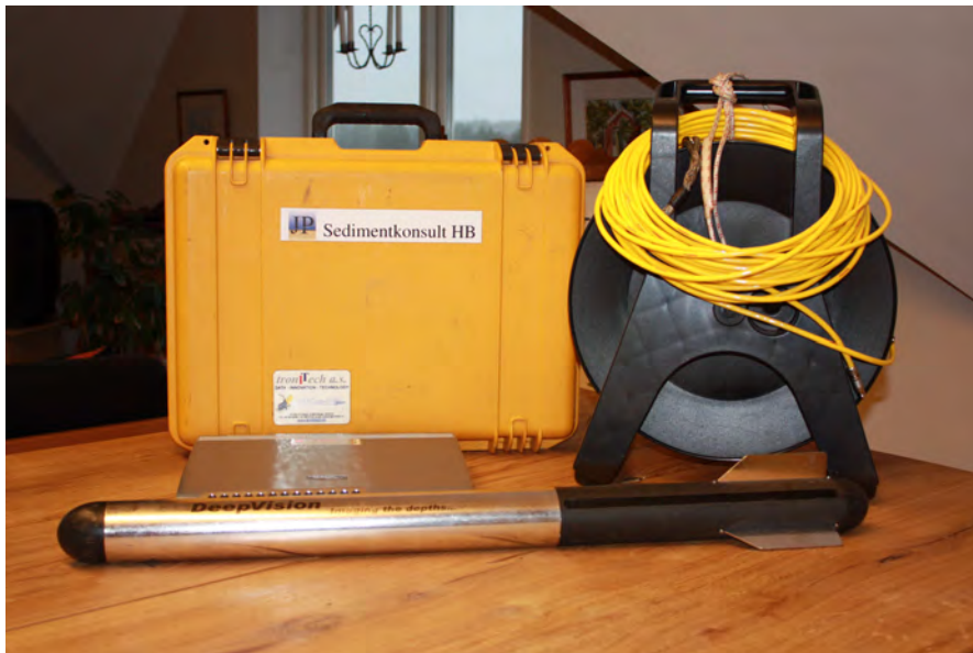
Figur 4 Portabel side scan sonar av typ DeepVision (340 KHz).
