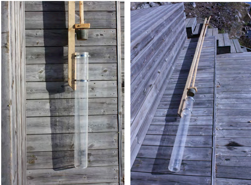
Figur 5 Den nyutvecklade Jonsson-hämtaren (Jonsson 2016).
