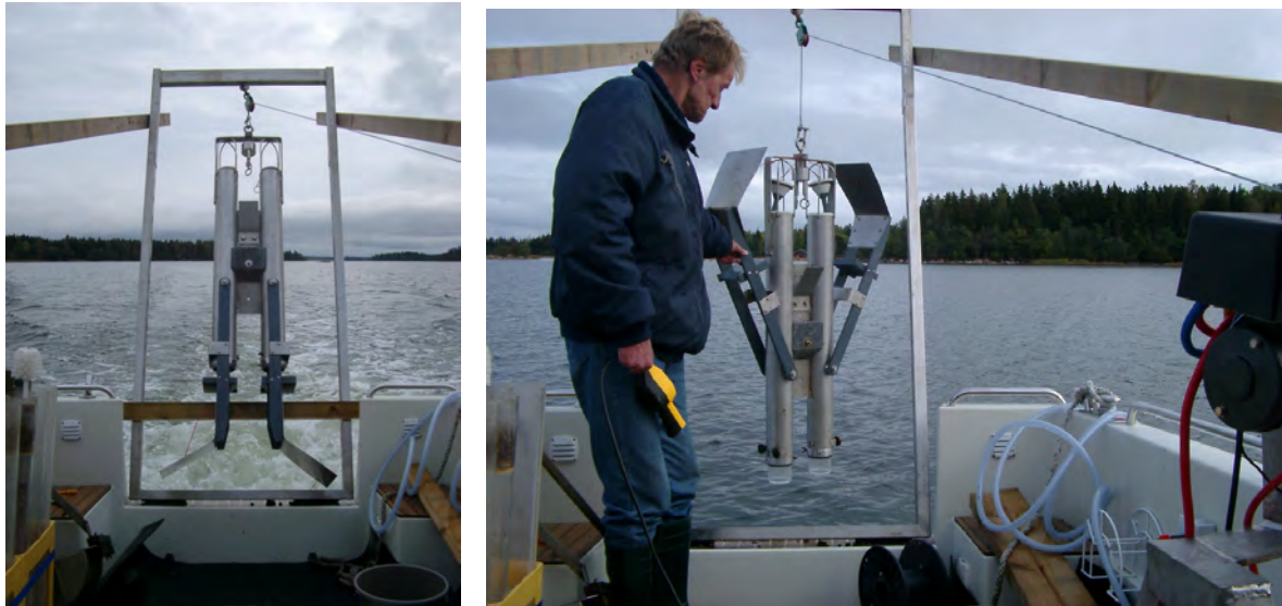
Figur 6 Vänster: Geminihämtaren transportsurrad. Höger: Laddad och redo för hugg.
