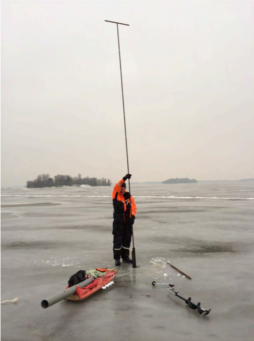
Figur 5 Provtagning med Rysskannborr från Västeråsfjärdens is 2014
