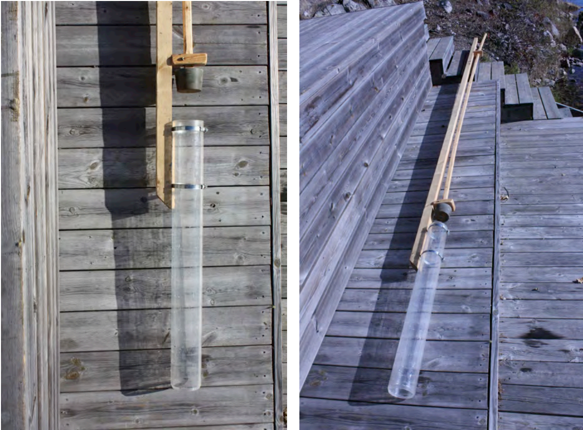
Figur 4 Jonsson-hämtaren (Jonsson 2016). Till vänster: nedre delen. Till höger: hela hämtaren.
