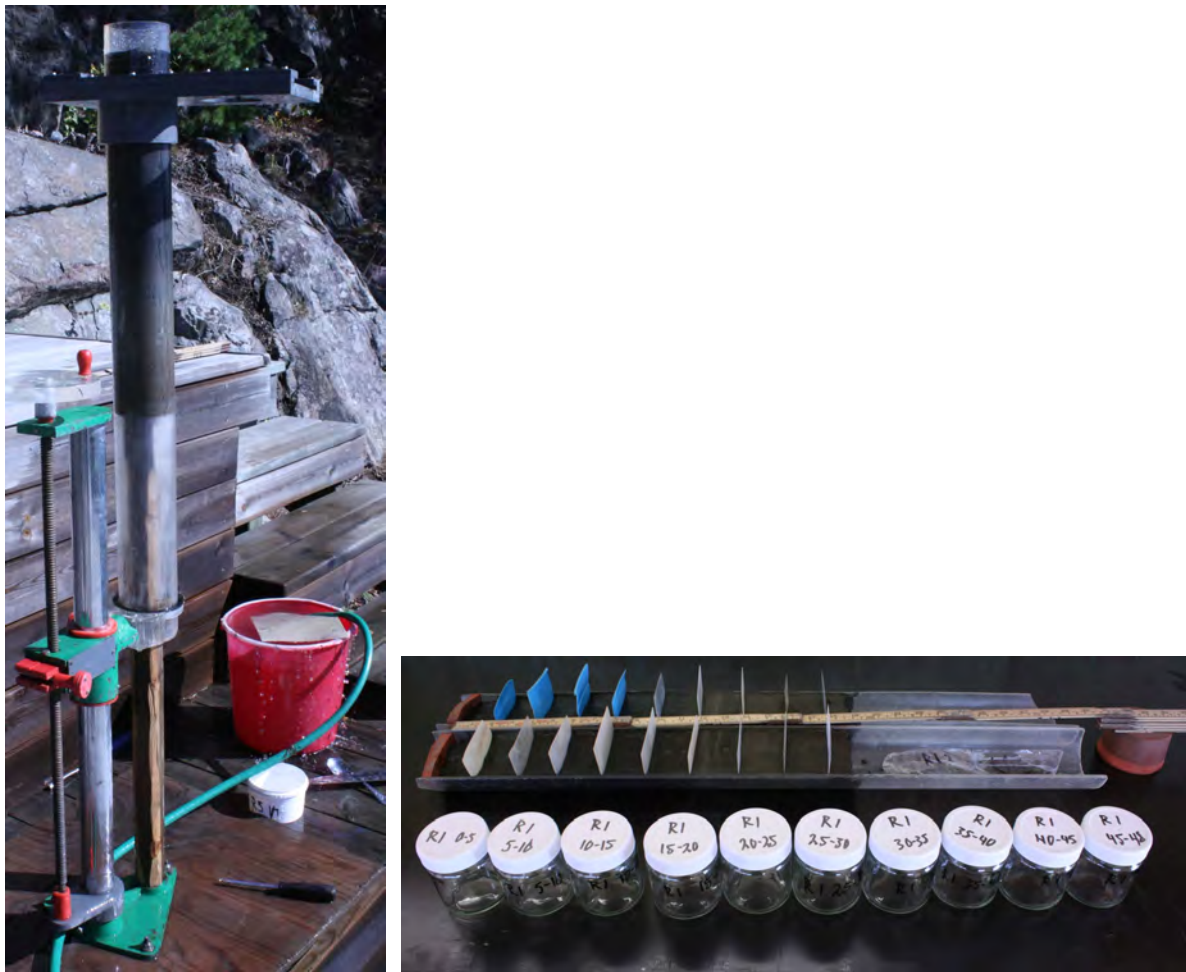
Figur 7 Vänster: Direkt snittning av Gemini-kärna. Höger: Provtagning av utskjuten Geminikärna.
