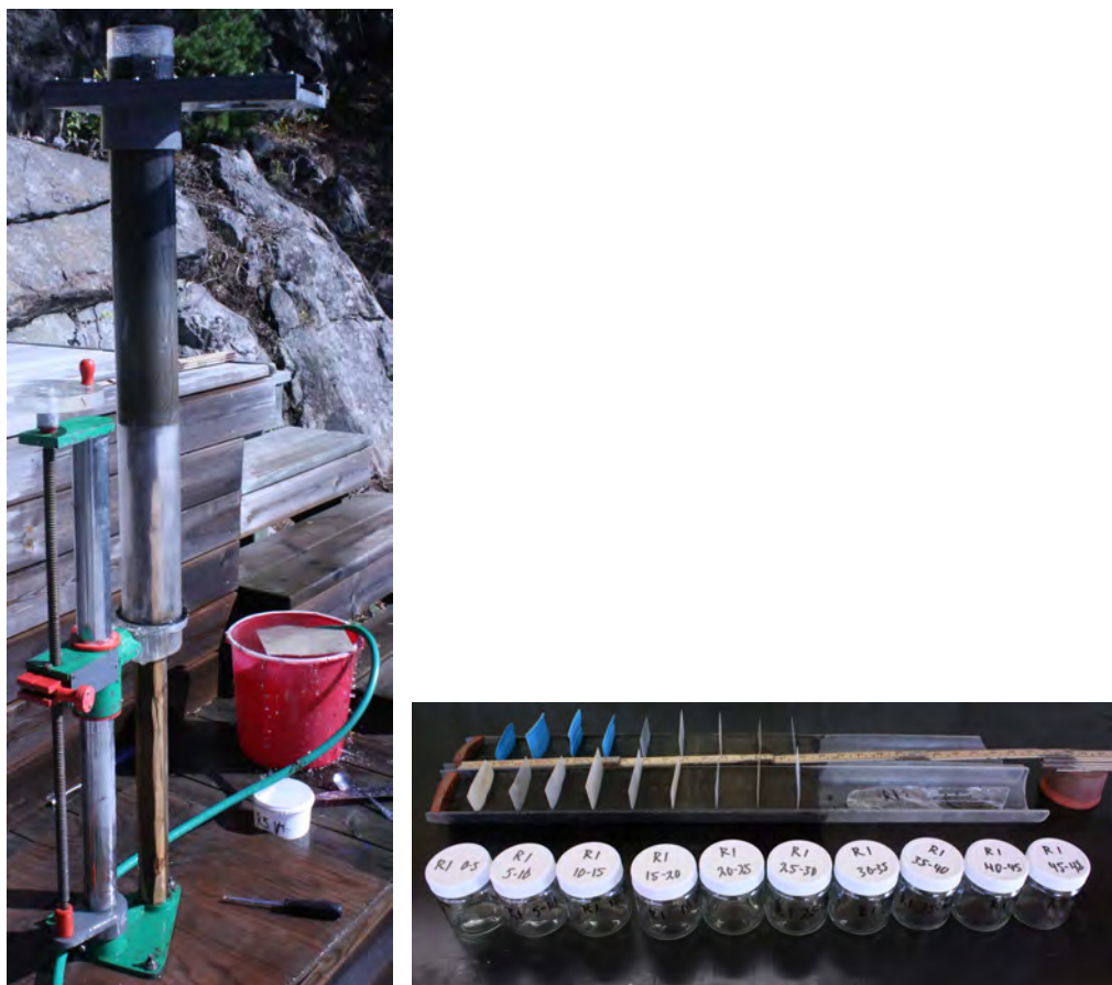
Figur 7 Vänster: Direkt snittning av Gemini-kärna. Höger: Provtagning av utskjuten Geminikärna.
