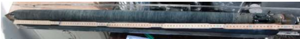
Figur 3 Rysskannborr som lagts i ett halvt sedimentprovtagningsrör och sedan öppnats och preparerats för dokumentation och provtagning.
