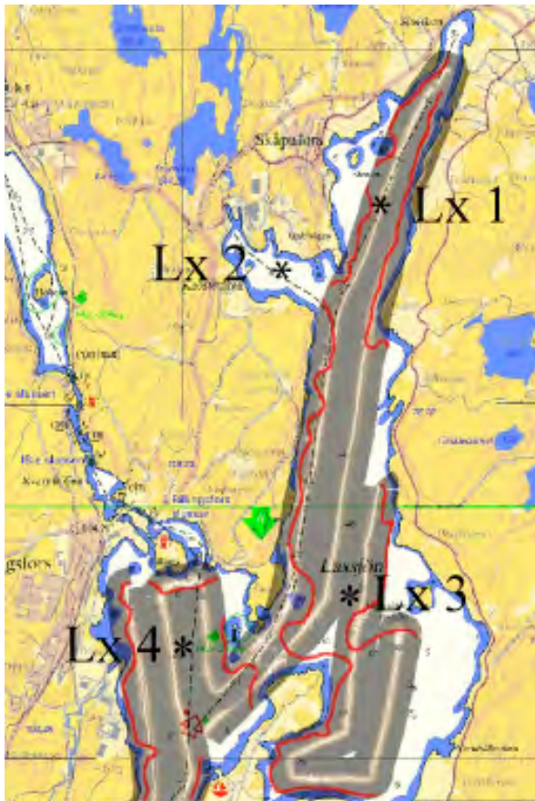
Figur 7 A Bottendynamisk karta för de centrala och norra delarna av Laxsjön med sedimentprovtagningsstationerna Lx 1-4 inlagda. Den röda linjen representerar gränsen mellan erosions- och transportbottnar å ena sidan och ackumulationsbottnar å den andra. Mer detaljerad karta finns i CD-bilagan.
