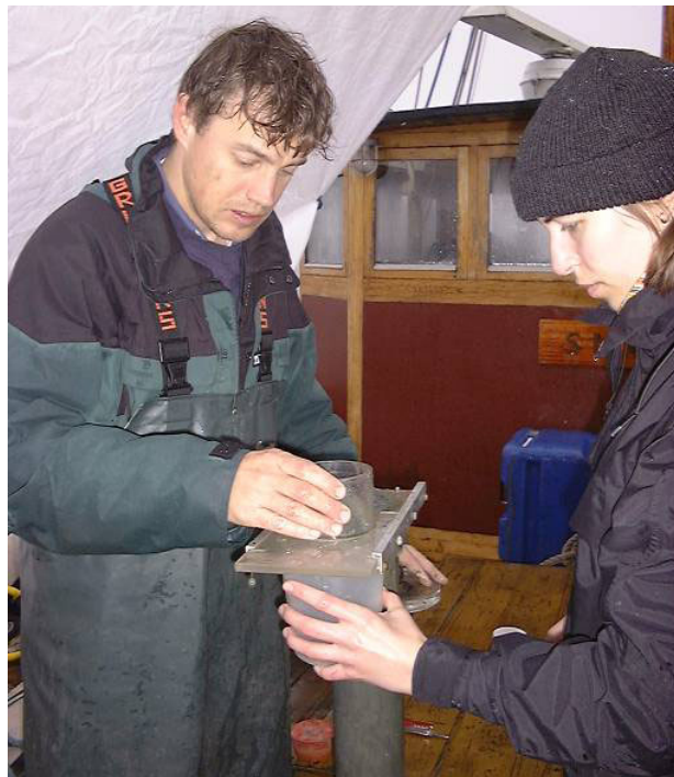
Figur 4 Snittning av sedimentkärnor i centimetertjocka varv.
