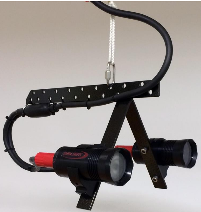
Figur 4 och 5. Vänster bild: Geminihämtare med bottenvideokamera monterad på sidoarm för filmning av provtagning vid sedimentytan. Höger bild: Bottenvideokamera Sublight Technology.
