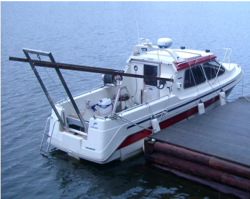
Figur 3. Provtagning utfördes från R/V Perca, på bilden med rigg för sedimenthämtarna monterad över aktern.
