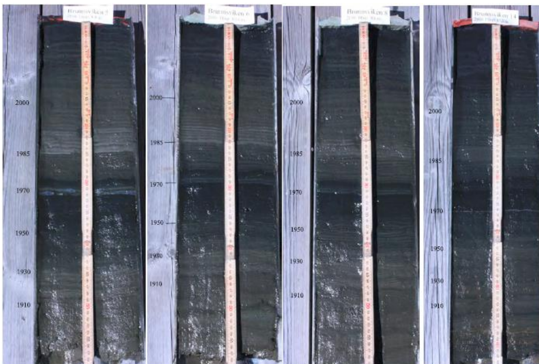
Figur 15. Daterade sedimentkärnor (B5, B6, B8, B14) med tydliga lednivåer ned till början av 1900-talet.
