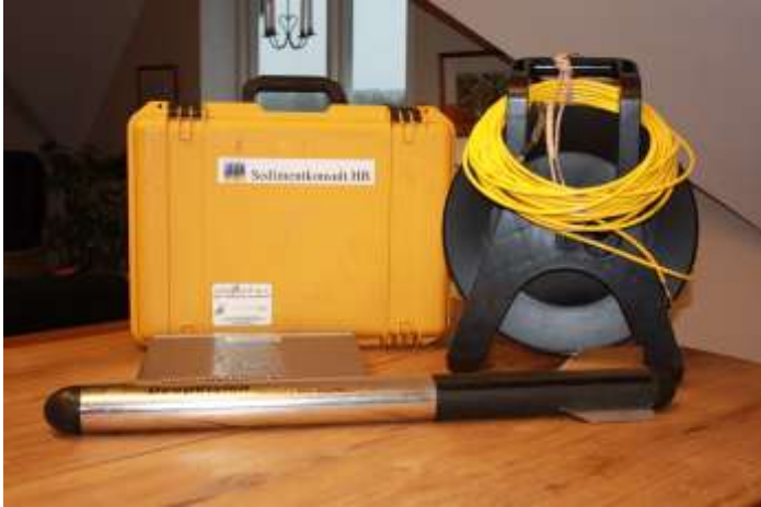
Figur 5 Portabel side scan sonar av typ DeepVision (340 KHz).
